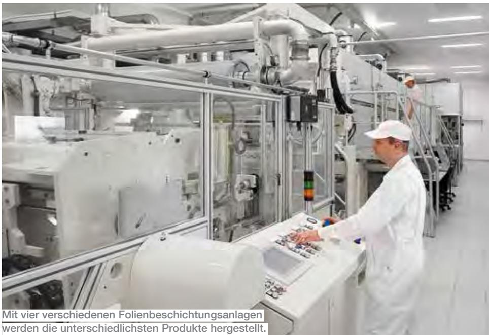
Mit vier verschiedenen Folienbeschichtungsanlagen werden die unterschiedlichsten Produkte hergestellt.
