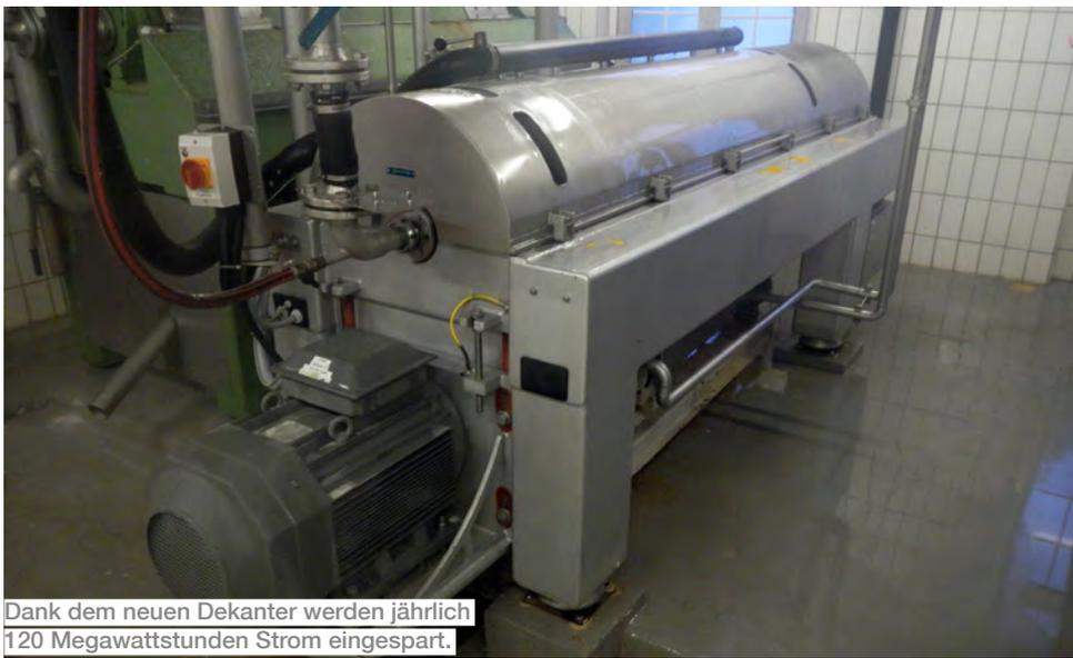
Dank dem neuen Dekanter werden jährlich 120 Megawattstunden Strom eingespart.
