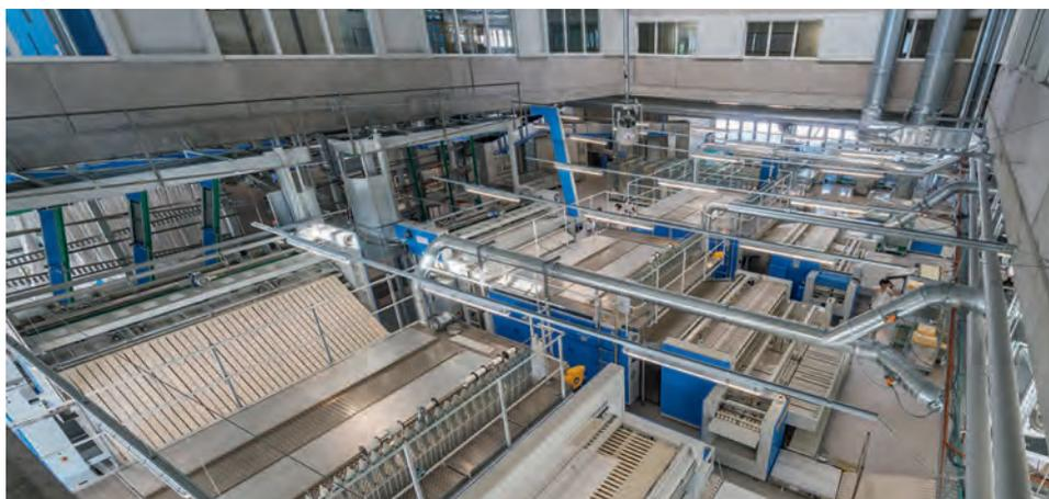
Die Abwärme der drei Wäschemangeln wird zur Wiederverwertung in einem 30 Kubikmeter grossen Wärmespeicher zurückgehalten.
