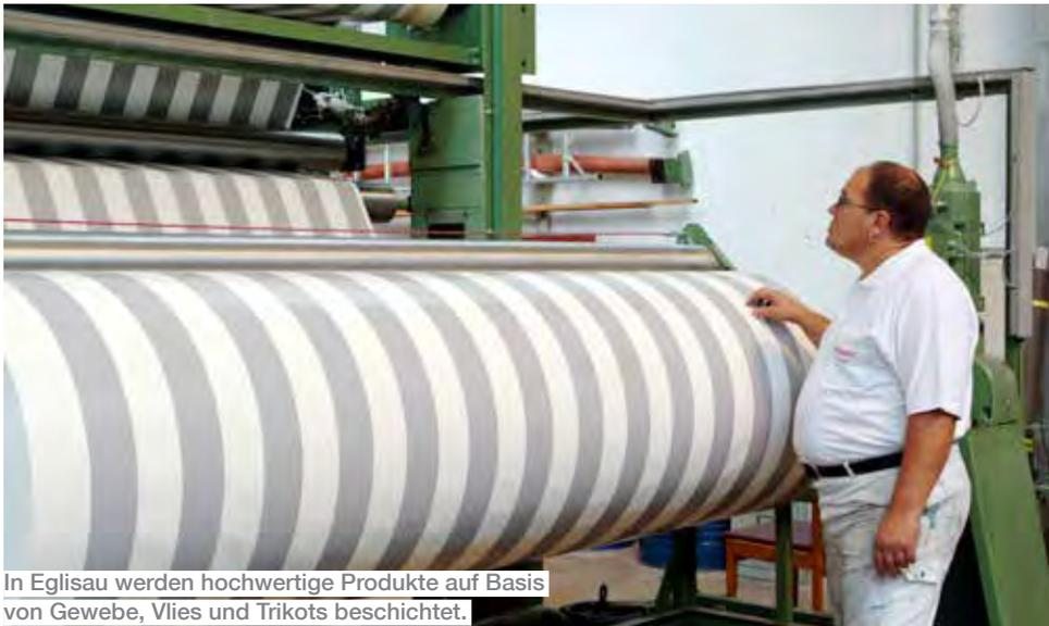
In Eglisau werden hochwertige Produkte auf Basis von Gewebe, Vlies und Trikots beschichtet.
