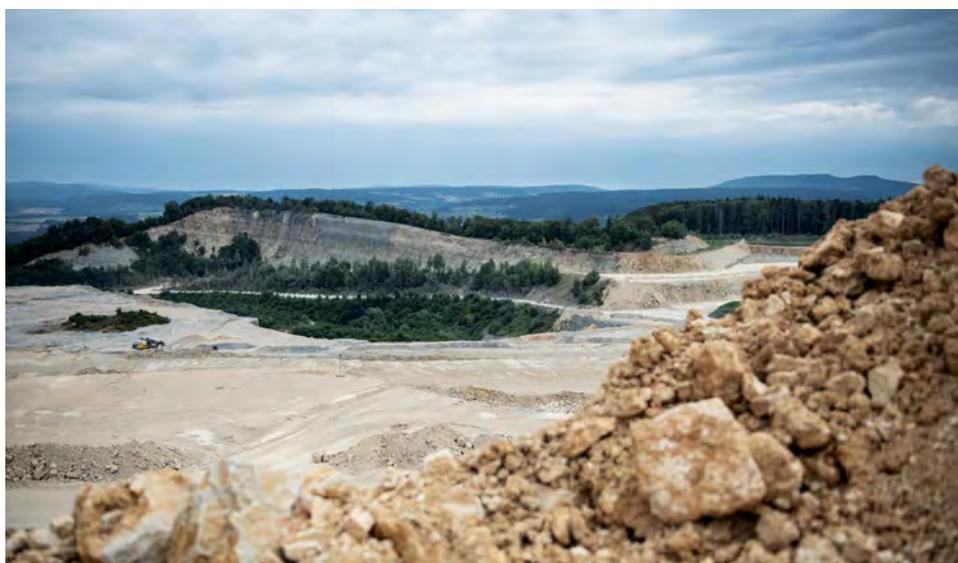
Im Steinbruch Gabenchopf der Holcim (Schweiz) AG am Standort Siggenthal werden Kalkstein und Mergel abgebaut – die Ausgangsstoffe für den Klinker des ressourcenschonenden Susteno-Zements.
