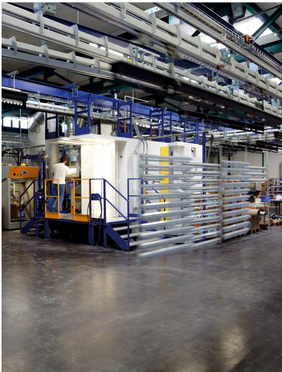
Mithilfe von Pulverbeschichtung werden Aluminiumstoren nach Wunsch in vielen Farben beschichtet.
