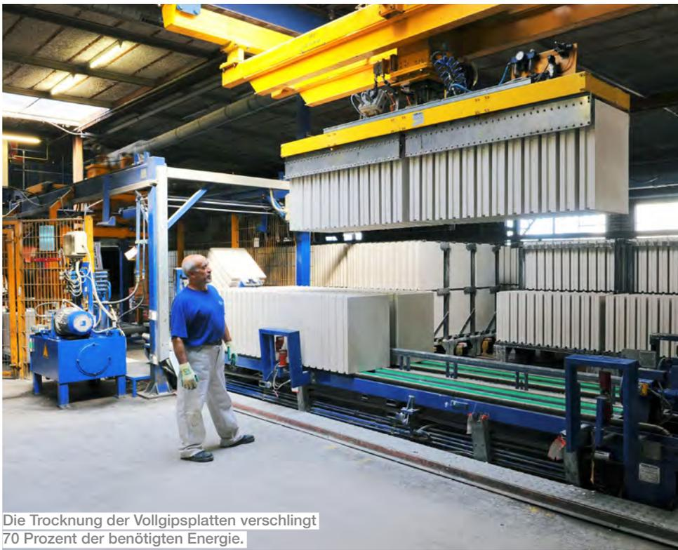
Die Trocknung der Vollgipsplatten verschlingt 70 Prozent der benötigten Energie.
