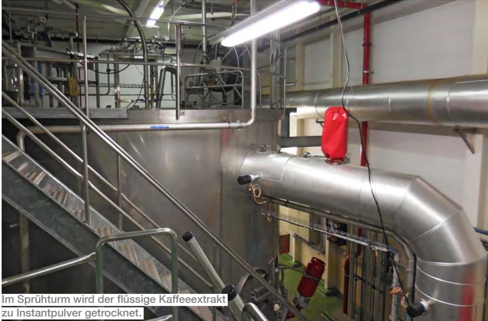
Im Sprühturm wird der flüssige Kaffeeextrakt zu Instantpulver getrocknet.
